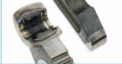
Partielle, doppelte Induktivhärtung
