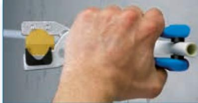
Sicheres Halten von kurzen Rohrstücken mit den hinteren Gummi-Puffern bei beengten Platzverhältnissen, z.B. bei Vorwandinstallationen. Das Außenrohr wird nicht beschädigt.
