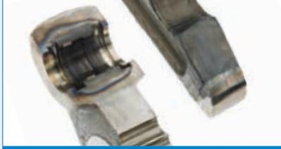
Partielle, doppelte Induktivhärtung
